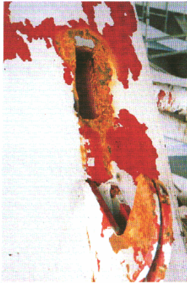
Figur 8.19 Skada på grund av avskiljning av babords sidolåsöra. Det manuella låsets öron.
